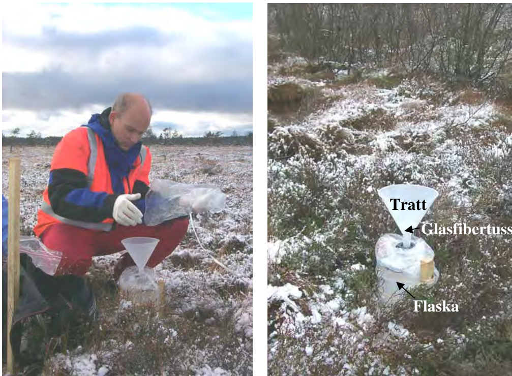
Figur 9 Utsättning av depositionsinsamlare.
