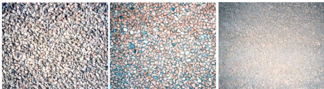
Figur 3. Schematisk bild som visar olika grader av inbäddning, a) ingen inbäddning, b) normal inbäddning och c) total inbäddning. Figur från (Jacobson, 2006).
