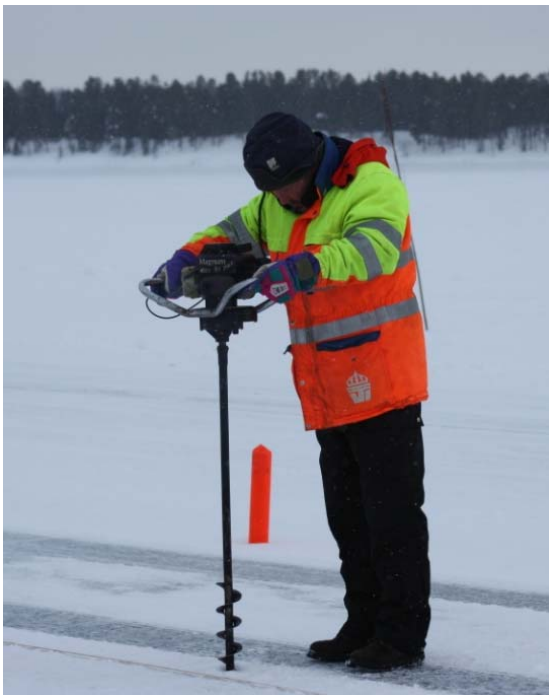
Figur 8 Skumgummifyllda koner placerades ut med hjälp av borrhål i isen.
