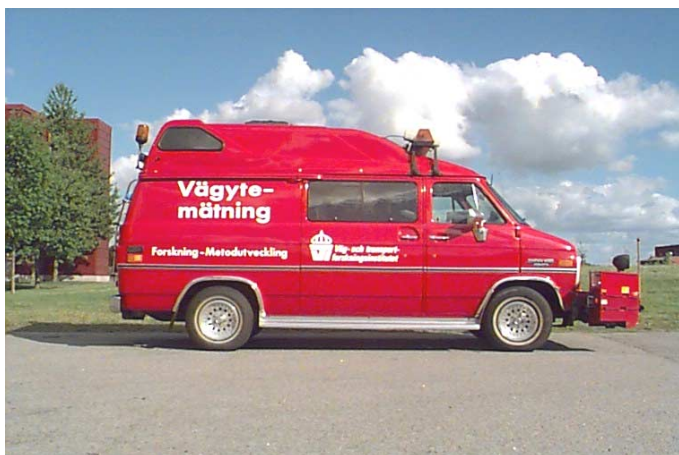
Figur 8 VTI:s vägytemätbil som används för vägytemätningar i det svenska LTPP-programmet.
