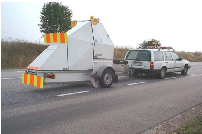
Figur 9 VTI:s fallviktsutrustning tillverkad av KUAB.
