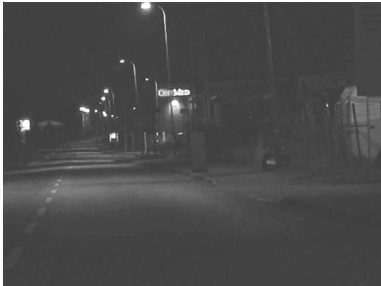
Figur 10 Försökssituationen med mörkt hinder strax bakom en ljuskälla som lyser med full effekt. Medelluminansen är ca 0,5 \text{ cd/m}^2 och luminansjämnheten 0. Observera att det egna halvljuset är släckt.
