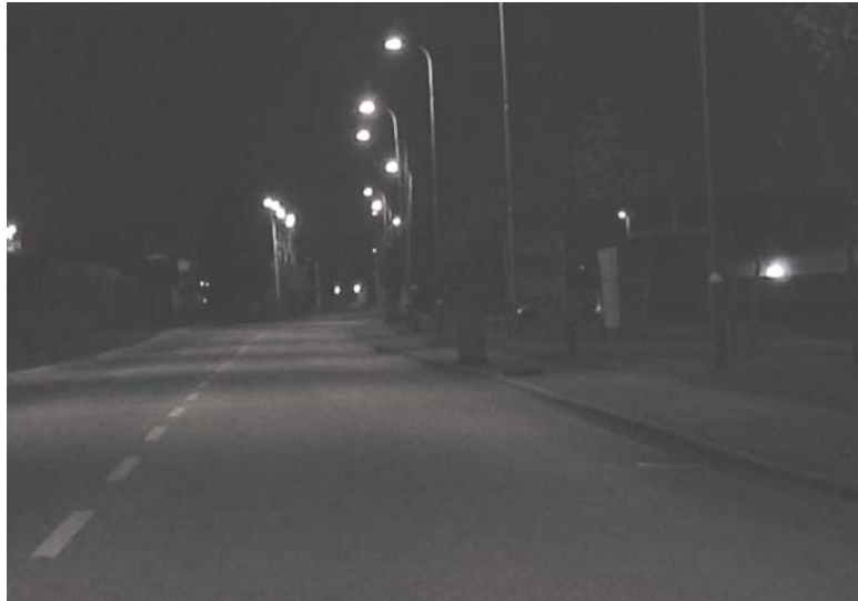
Figur 3 Försökssituationen med mörkt hinder mitt emellan två ljuskällor som lyser med full effekt. Medelluminansen är ca 1 \text{ cd/m}^2 och luminansjämnheten ca 0,4.
