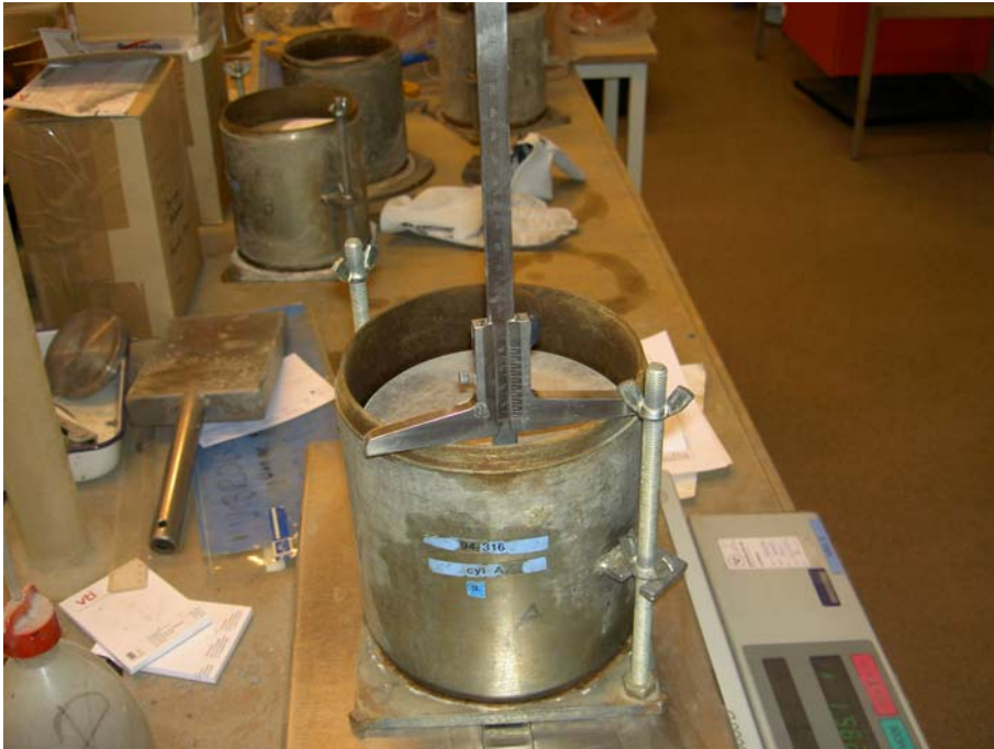
Figur 5 Mätning av provvolymer i packningscyllindrar, prover stannade på våg.
