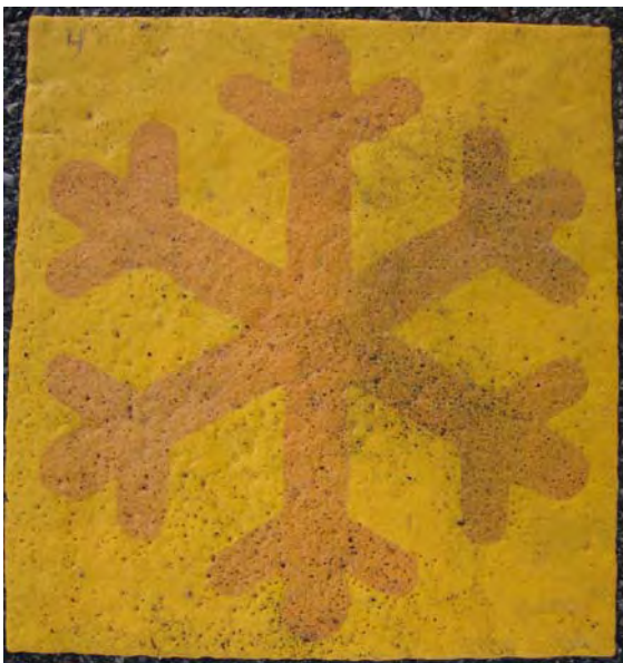
Figur 8 Den nytillverkade halkvarnaren på VTI:s bakgård hade skrubbedes med en stålborste på höger sida för att efterlikna dubbdäcksslitage. Foto: Sara Nygårdhs, VTI.
