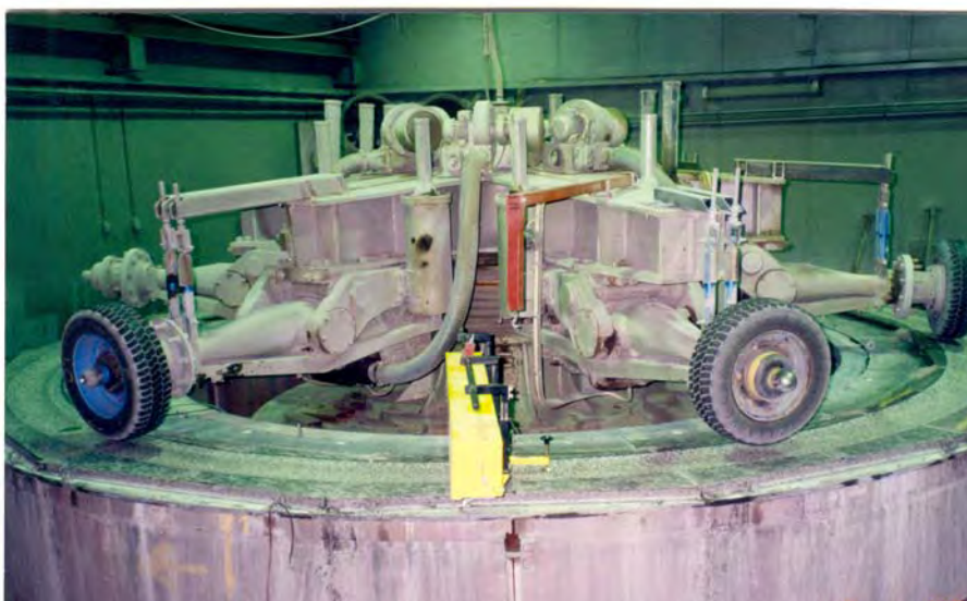
Figur 5 Provvägsmaskinen med laserprofilometern.
