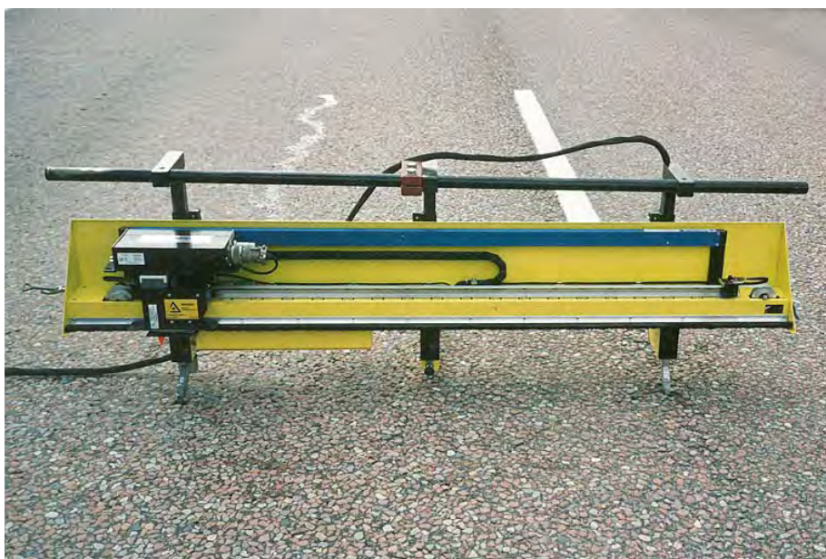
Figur 4 VTI:s laserprofilometer för avnötningmätning.
