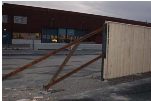
Figur 19 Den, i längsled kraftigt förstärkta bullerskärmen, inför prov 3. Övriga förutsättningar är samma som i det första provet.
