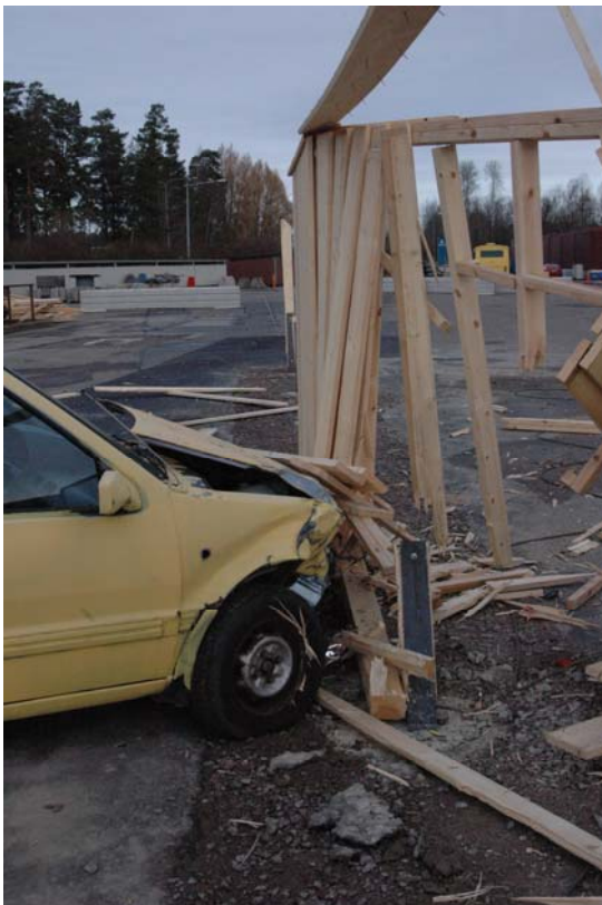
Figur 22 Prov 3 efter kollision. Notera att fordonet inte åker igenom planket utan blir kvar på vägsidan.
