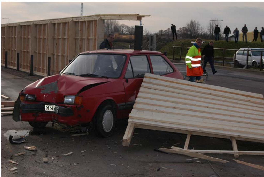
Figur 12 Efter kollisionen. Bilen är måttligt skadad. Med största sannolikhet är det infästningen mot marken som har tryckt in fronten.
