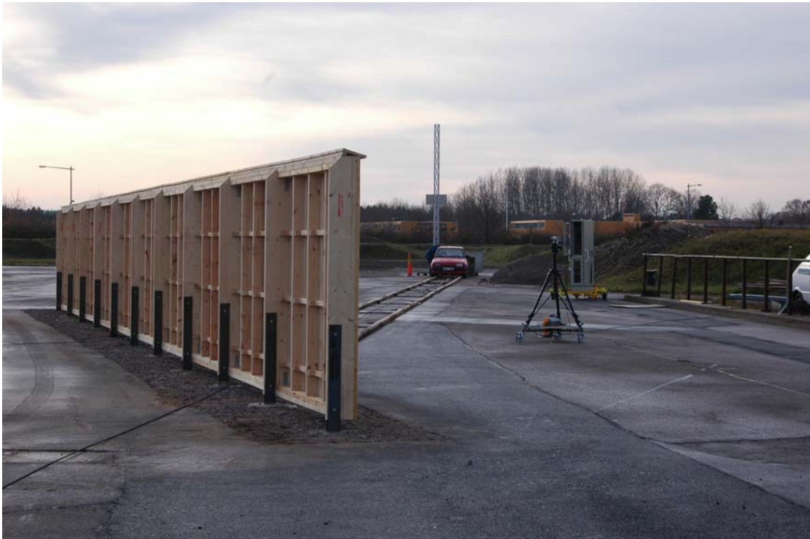
Figur 9 Uppställning inför prov 1. Observera att dragvajern släpper från bilen strax innan den träffar bullerskärmen.
