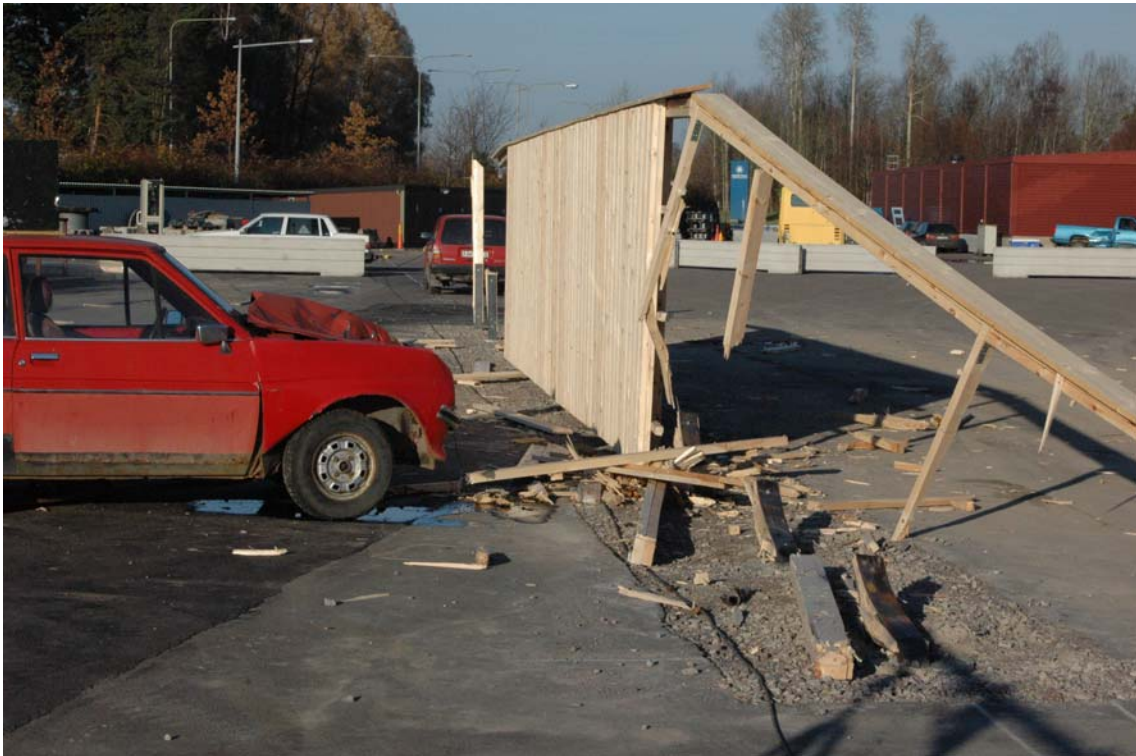
Figur 16 Prov 2 efter kollision. Observera att den överliggande regelkonstruktionen hänger kvar och inte splittrats på det sätt som själva planket gjort.
