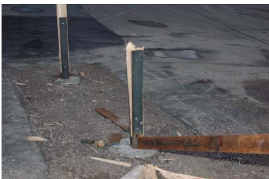
Figur 20 Detaljbilder på förstärkningen i längsled inför prov 3. Observera att förstärkningen inte kommer att träffa bilen utan bara styvar upp planket i längsled.
