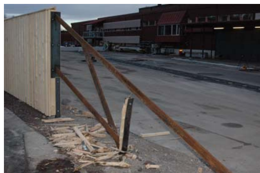
Figur 20 Detaljbilder på förstärkningen i längsled inför prov 3. Observera att förstärkningen inte kommer att träffa bilen utan bara styvar upp planket i längsled.
