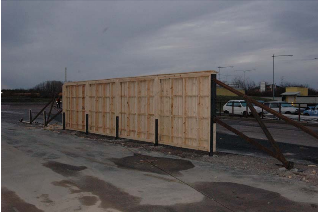
Figur 19 Den, i längsled kraftigt förstärkta bullerskärmen, inför prov 3. Övriga förutsättningar är samma som i det första provet.
