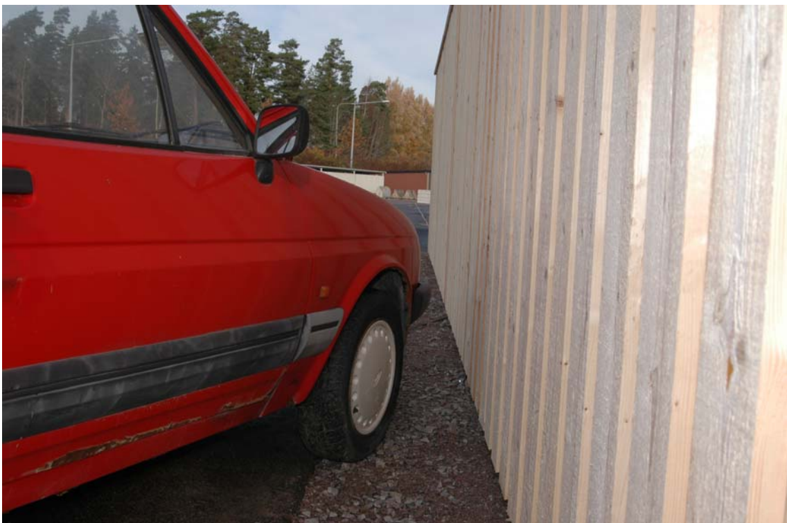
Figur 10 Bilen invid bullerskärmen före kollisionen.
