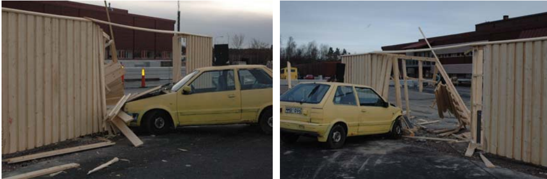
Figur 23 Ytterligare bilder efter kollisionen. Observera att planket är igenombrutet men att stagningen i längsled har fungerat, planket är helt i båda ändar.
