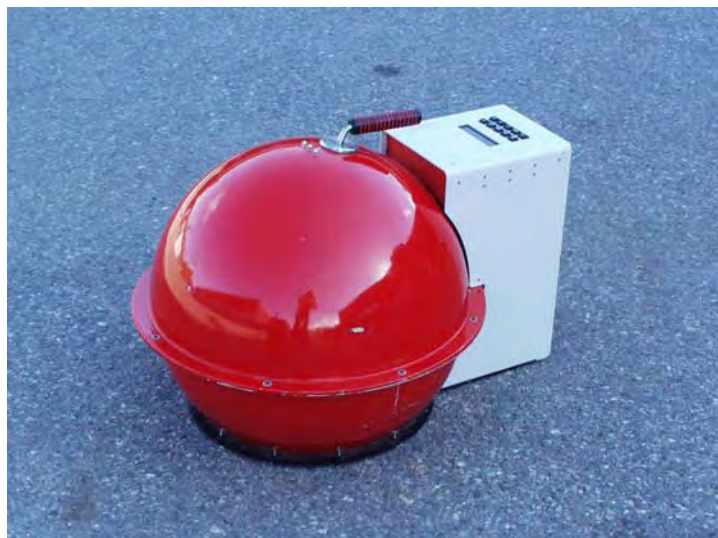
Figur 6 Qd30 för mätning av luminanskoefficient, Q_d .
