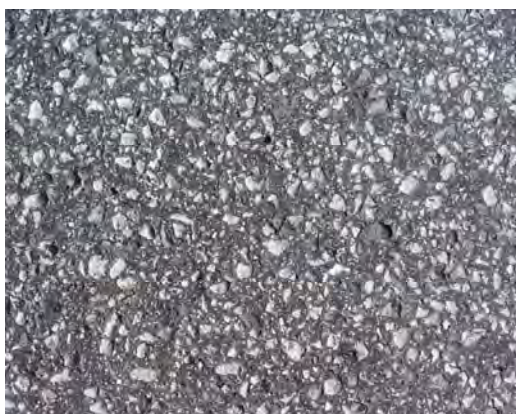
Figur 11 Mjuk asfaltbetong med stenstorlek 11 mm.
