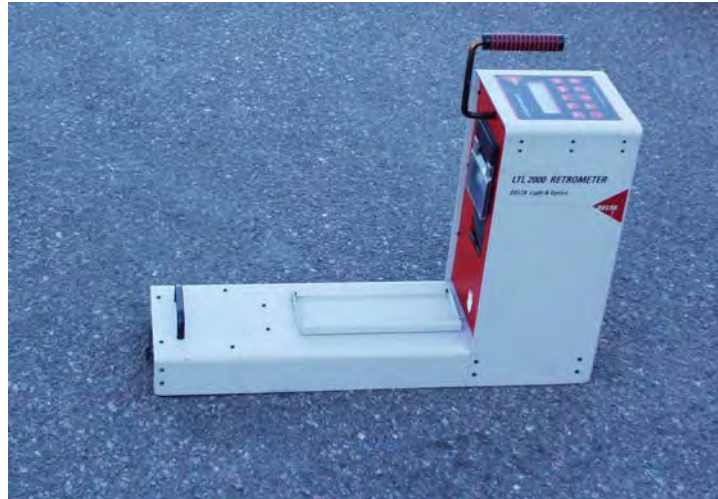
Figur 5 LTL2000 för mätning av retroreflexion, R_L .
