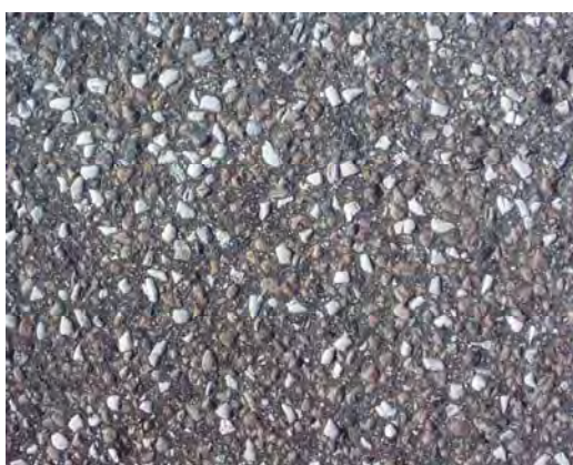
Figur 10 Asfaltbetong med stenstorlek 11 mm.
