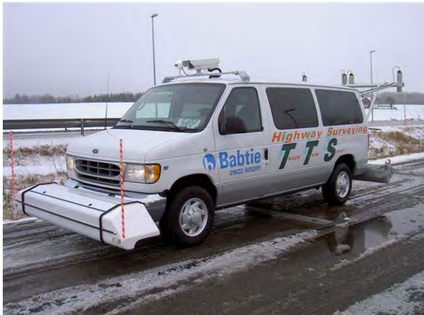
Figur 1 PAVUE mätbil, sprickutrustningen är monterad bak på bilen.
