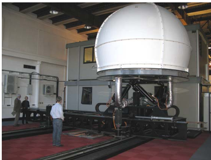
Figur 2 Simulatoren i Leeds, av samma typ som den som föreslås i Göteborg. En viktig skillnad är dock att Göteborgs-simulatoren ska ha ett system för byte mellan personbils- och lastbils-kabin.
