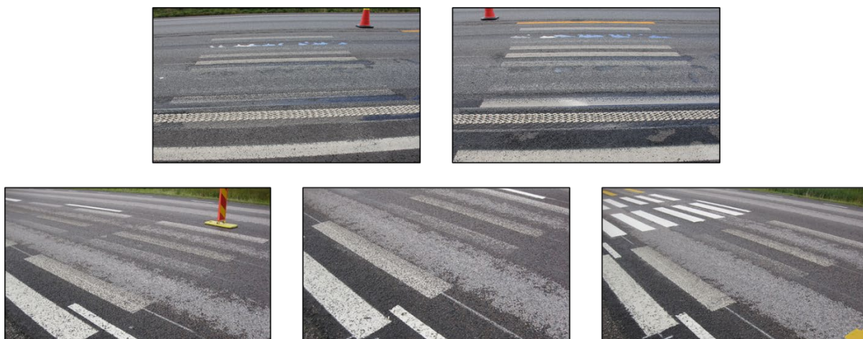
Figur 16. Slitna material med stora glaspärlor på provfält ett år efter utläggning. Ovan från vänster: Material 1 och material 2. Nedan från vänster: Material 3, 4 och 5.
